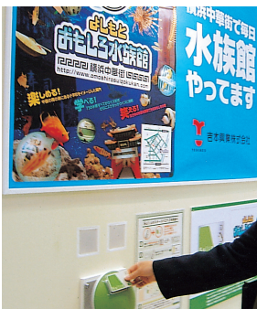
上野駅「Suicaポスタースクエア」で読み取り機にSuicaをタッチするとポスターに表示されている商品・サービスの詳細情報やキャンペーン応募情報、企業情報が携帯電話にメール送信される
